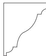
SG.H.2117: Sottogronda Altezza 214 mm Profondità 168 mm Lunghezza 1000 mm
