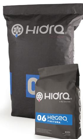
Rasante per finiture di colore grigio, per esterno - interno a base di cemento grigio 52.5, additivi specifici e sabbia silicea c.a. Ø 0,2 - 0,6mm, con proprietà di deumidificazione o impermeabilizzazione nell'ambito di specifici cicli applicativi. Impiego esclusivo per finiture di cicli di deumidificazione ed impermeabilizzazione Hegea.
