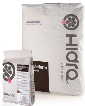
Rasatura cementizia di colore grigio, per esterno - interno, a finitura civile. Composta da inerti selezionati a granulometria 0,6mm, leganti idraulici e aerei, additivi e fibre, risulta idonea per rasare e stuccare intonaci a base cemento, stagionati, recenti e vecchi (non sfarinanti). Permette di ottenere finiture di tipo civile.
